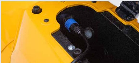
Während des Aufladens der Batterie(n) im Inneren der Schwalbe, wird der Status auf dem Cockpit-Bildschirm angezeigt. Wenn das Ladegerät nur mit dem Roller verbunden ist, aber nicht an die Steckdose angeschlossen ist, erscheint die Meldung im Cockpit „Check connection“ / „Verbindung prüfen“.
